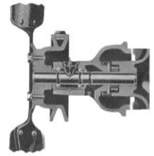
FIG. 15 -- WATER PUMP ASSEMBLY
