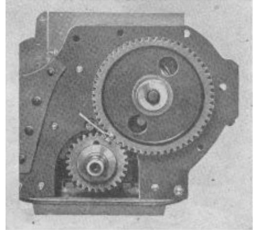
FIG. 8 -- TIMING GEAR MARKS
