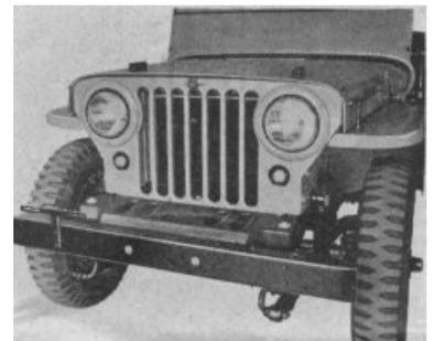
FIG. 37 -- FRONT BUMPER WEIGHT
